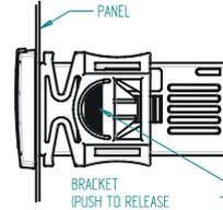
XR60CH Cihazı dık bir panoya, 29x71mm ebatlarında bir yuvaya, tedarik edilen özel klipslerle monte edilmelidir. Cihazın doğru çalışması için olması gereken sıcaklık 0+60 °C aralıktır. Cihazı titreşimli, zararlı gazlı, kirlili ve aşırı nemli ortamlara yerleştirmeyin. Aynı koşulların Sensörler içinde sağlanması gerekmektedir.
